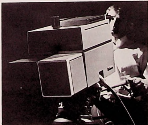
Afb. 1. Deze automatische kleuren-televisie-camera heeft als bijzonderheid een gespecialiseerde miniatuur-computer, die een nagenoeg onmiddellijke kleurenbalans en juiste instelling geeft met een enkele druk op de knop. De camera is bekend geworden als de Mark - VIII van Marconi.
