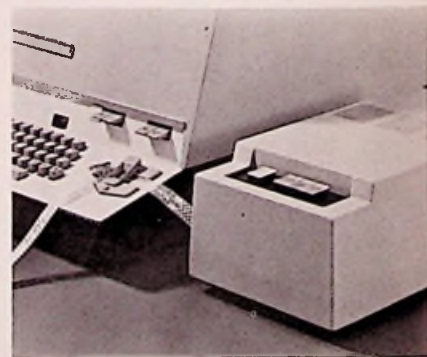
SEL-(de)codeerschakeling voor meer privacy bij het openbare telexnet.
